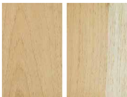
Figura N° 21. Corte tangencial y radial de madera de C. fissilis
