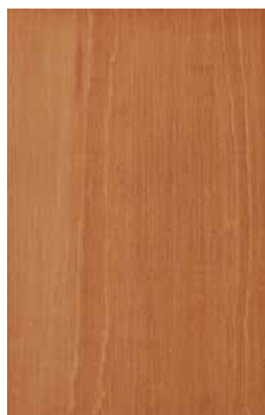
Figura N° 21. Corte tangencial y radial de madera de C. fissilis
