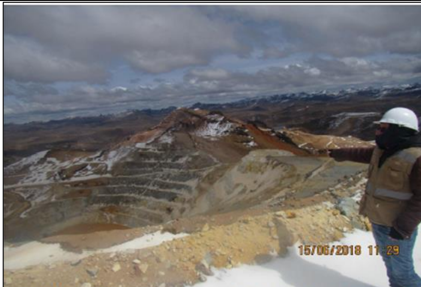
Fotografía N° 36: Vista fotográfica de la cantera Jessica, obsérvese que en ningún lado existe los sistemas hidráulicos que protejan a la cantera de las lluvias. Coordenadas Geográficas UTM (WGS84-19L): E-305952; N-8313912, Altitud-5168 msnm.
