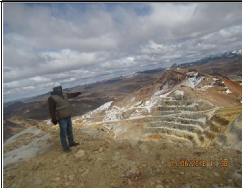
Fotografía N° 37: Vista fotográfica de la cantera Jessica, tomado desde otra perspectiva obsérvese que en ningún lado existe los sistemas hidráulicos que protejan a la cantera de las lluvias.
