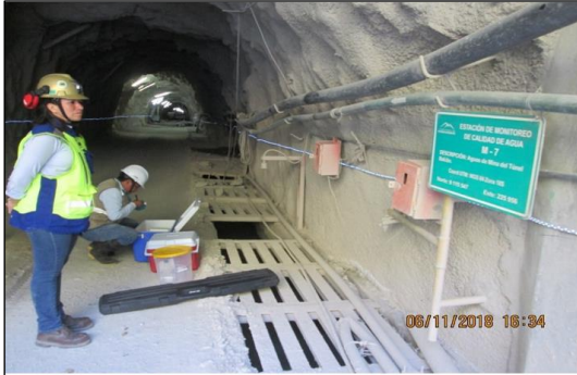
Fotografía N° 122.- Punto de control M-7. Punto ubicado al ingreso de la rampa J.N.G. Nivel 2430 – identificado como Túnel Balcón, con descarga al río Parcoy. Coordenadas WGS 84, zona 18M, (E 225915, N 9115517). Recolección de la muestra realizada por el personal del OEFA del punto de control M-7 al ingreso de la rampa J.N.G. Nivel 230.
