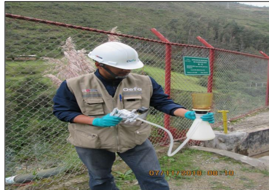
Fotografía N° 128.- Punto de control M-12. Vista de filtrado para el parámetro de metales disueltos, realizado por los analistas del OEFA.
