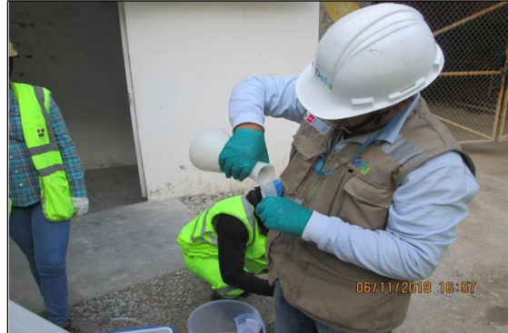
Fotografía N° 123.- Punto de control M-7. Vista de filtrado para el parámetro de metales disueltos, realizado por los analistas del OEFA.
