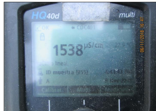
Fotografía N° 125.- Punto de control M-7. Resultado del parámetro de campo Conductividad Eléctrica C.E.=1538 µS/cm.
