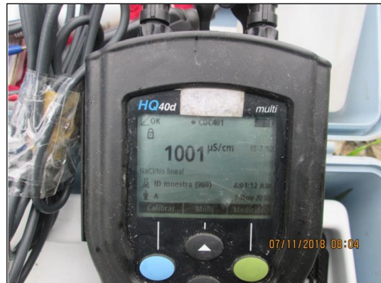
Fotografía N° 130.- Punto de control M-12. Resultado del parámetro de campo Conductividad Eléctrica C.E.=1001 µS/cm.
