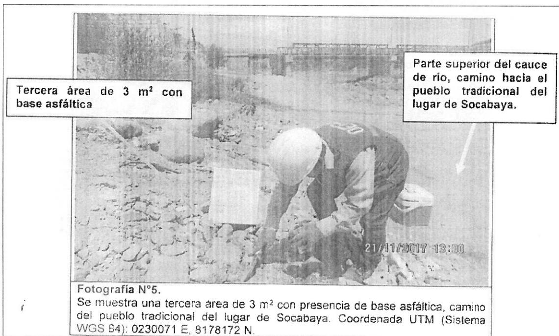
35. Asimismo, cabe resaltar que se procedió a tomar una muestra sobre la base asfáltica a fin de encontrar la presencia de hidrocarburos. En función a ello,
