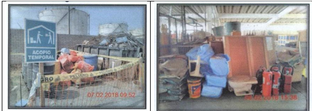
Fotografía N° 3 y 4: Residuos que exceden la capacidad de los contenedores en el sector N° 2 y envases, materiales en desuso, restos de madera, equipos mobiliarios y extintores almacenados inadecuadamente en almacén principal.
