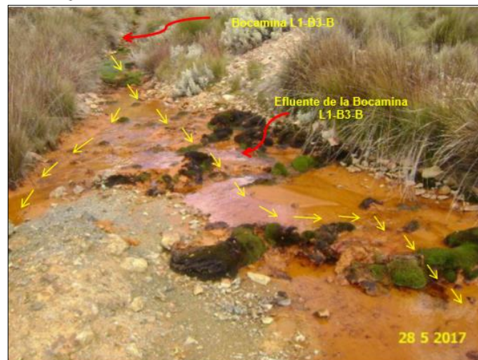
Vista del efluente de la bocamina L1-B3-B de color naranja oscuro con presencia de lodos del mismo color, que discurre cuesta abajo hacia el depósito de desmonte L1-D7-B.
