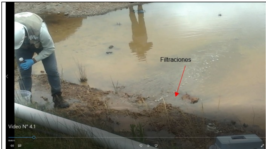
Imagen N°4: captura de imagen a los 11 segundos del video N°4.1, que detalla el punto en el cual se verificaron las filtraciones provenientes de la poza de solución cianurada, en las coordenadas UTM WGS 84 Zona 17 E769190, N9254201.
