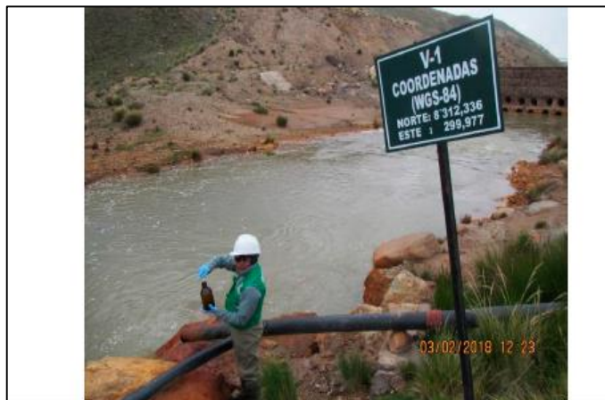
Fotografía N° 224. Vista del punto de muestreo de efluente V-1, se observa que la muestra es preservada de acuerdo con los criterios de preservación de cada parámetro.
