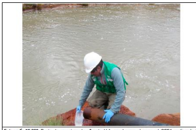
Fotografía N° 228. Punto de muestreo de efluente V-1, se observa al personal OEFA realizando la medición del caudal.
