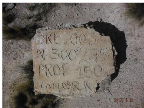
**Fotografía N° 4 del panel fotográfico:** Vista del dado de concreto ubicado en la Plataforma P-18. El dado de concreto contenía la información del sondaje realizado en la plataforma en mención.
