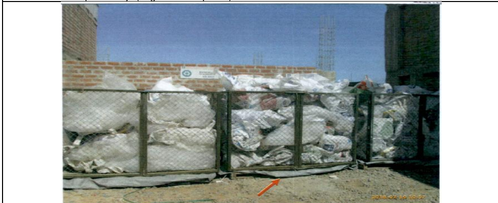
Fotografía N° 25: De la vista anterior, los contenedores metálicos son colocados sobre parihuelas de madera y sobre terreno afirmado cubierto de costales de polietileno y a la intemperie.
