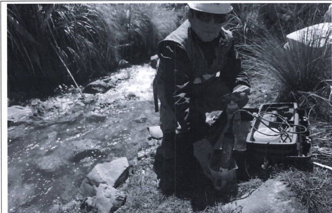
Fotografía N° 38: HALLAZGO N° 1: Se observó filtraciones de agua a 2 metros del cauce del río El Tingo, con un pH de 7,11.
