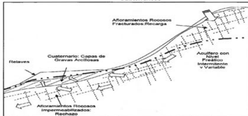
Esquema de Hidrogeología del área en estudio indicando la dirección del Flujo de las Aguas Subterráneas
