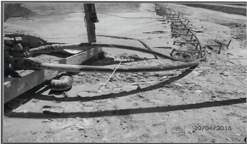
Fotografía N° 168: Hallazgo 15: Vista fotográfica donde se observa material de relave sobre el suelo alrededor del cicloneador sur, ubicado en las coordenadas UTM WGS 84 501325 E, 8555699 N.
