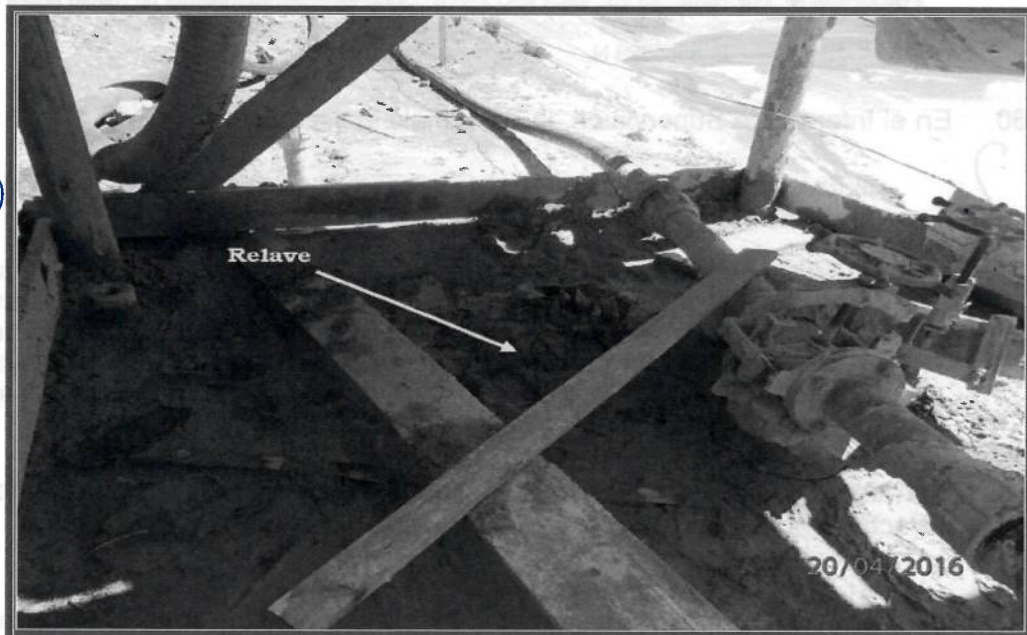
Fotografía N° 169: Hallazgo 15: Vista fotográfica donde se observa material de relave sobre el suelo alrededor del cicloneador sur, ubicado en las coordenadas UTM WGS 84 501325 E, 8555699 N.
