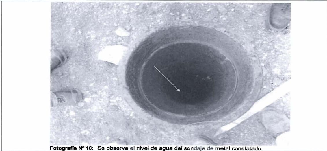
Fotografía N° 10: Se observa el nivel de agua del sondaje de metal constatado.
