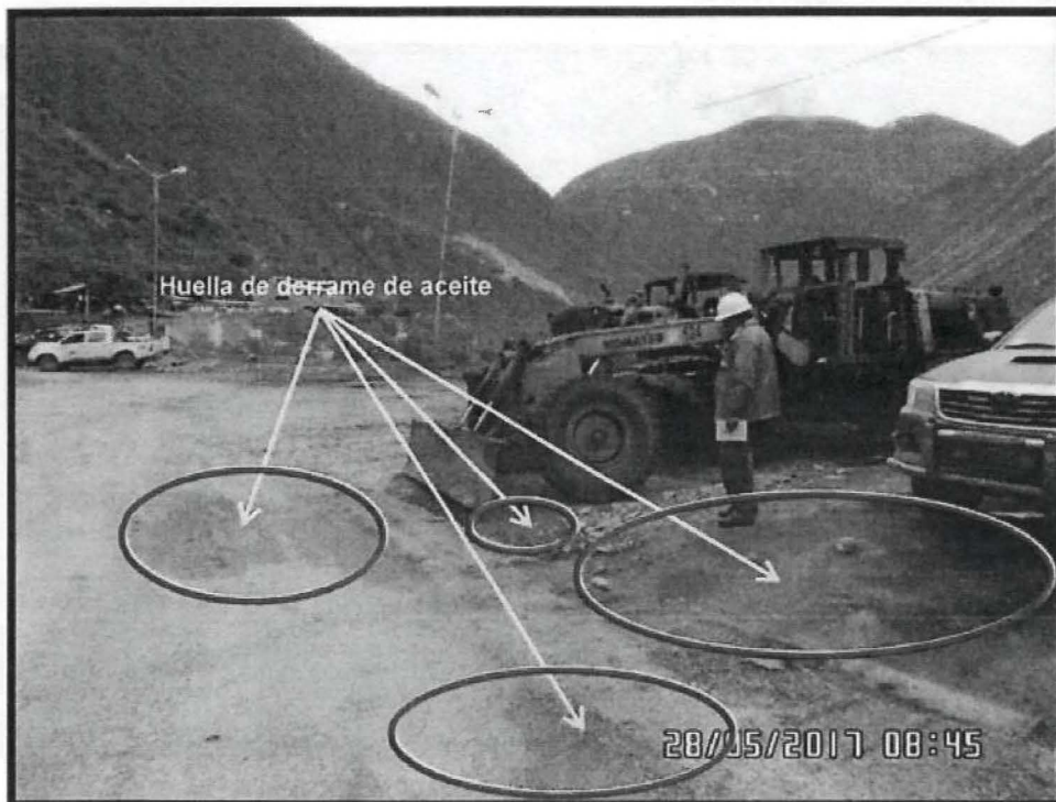
FOTOGRAFÍA N° 4e (Presunto Incumplimiento N° 02): Huella de derrames de aceite en la superficie de la plataforma del Nv. 28, adyacente al taller de mantenimiento de electrojumbos.
