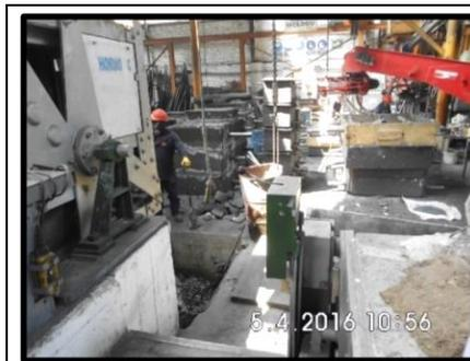
**Foto N° 7:** Hornos de inducción en pleno funcionamiento, se observa la escoria generada que es contenida en una infraestructura de concreto.
