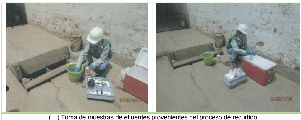
(...) Toma de muestras de efluentes provenientes del proceso de recurtido
