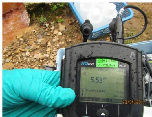
**Fotografía N° 109:** Vista de la pantalla del equipo multi-parámetro Hach, donde se observa la lectura de 5,53 unid de pH, en el punto de muestreo ESP-1.
