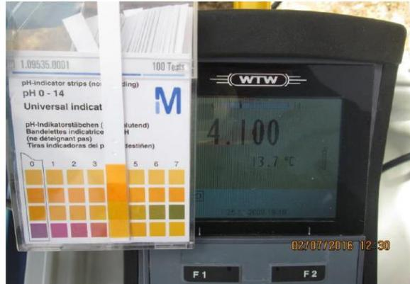
**Fotografía N° 91:** Otra vista de los parámetros de campo pH (4.10 unid. de pH) en el punto de muestreo MCH-05 con coordenadas UTM (WGS 84), E: 795626 N: 9220949 Zona 17.
