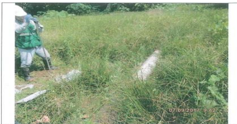
Fotografía N° 6-B. Zona de derrame - Km 51+875. Terreno adyacente al DDV (margen izquierdo) rodeado de vegetación. Durante el sondeo de comprobación de calidad de suelos, se advirtió presencia de una sustancia oleosa. Se recabó muestras de suelo para su análisis correspondiente. Coordenadas UTM (WGS84): 9531967 N / 492962 E.
