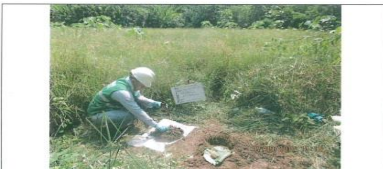
Fotografía N° 6-C. Zona de derrame - Km 51+875. Terreno adyacente al DDV (margen izquierdo) rodeado de vegetación. Durante el sondeo de comprobación de calidad de suelos, se advirtió presencia de una sustancia oleosa. Se recabó muestras de suelo para su análisis correspondiente. Coordenadas UTM (WGS84): 9534293 N / 491603 E.
