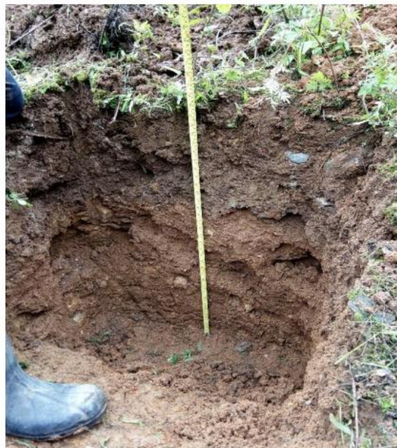
Fotografía N° 4: Vista de los horizontes identificados en la calicata realizada en el depósito de relaves La Catedral.
