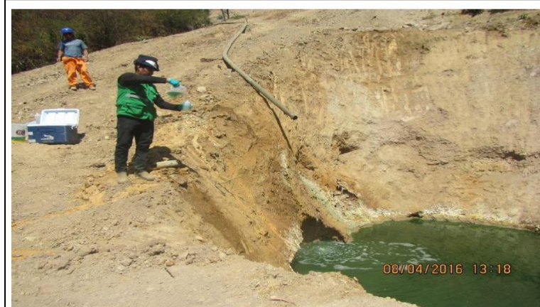
Fotografía N° 156: Personal del OEFA realizando la toma de muestra del efluente ESP-2 - Agua de la poza de tratamiento manual del subdrenaje de la relavera Higospampa, que descarga a la poza de tierra, con coordenadas (UTM WGS-84), E 777022 N 9160597.
