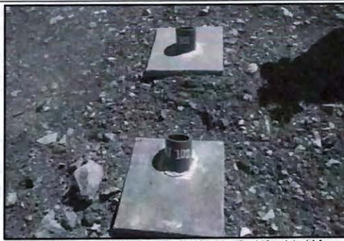
Fotografía N° 131: Incumplimiento N° 01: Otra Vista fotográfica del área de la plataforma PLT-22, donde se observa dos sondejos de los diez verificados, dichos sondejos no presentaban afloramiento de agua.
