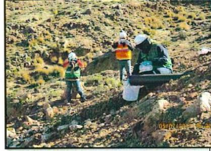
Fotografía N° 127: Toma de muestras del efluente de la poza de monitoreo de subdrenajes del sistema de tratamiento pasivo – wetland, en la tubería de HDPE de 6 pulgadas de diámetro, con un pH de 2.82, Temp. = 14.8 °C, una conductividad de 6300  $\mu$ S/cm y caudal = 0.028 L/s. Muestra tomada con código ESP-6.
