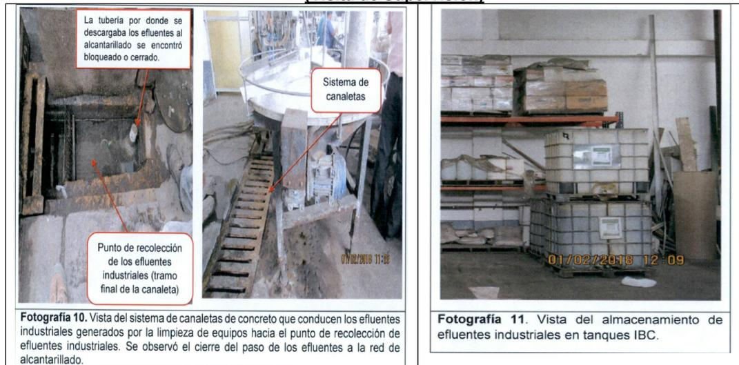
22. Del análisis de las fotografías N° 10 y 11, se advirtió que el administrado únicamente contaba con canaletas de concreto cubiertas con rejillas metálicas - para el desplazamiento de los efluentes industriales. Asimismo, se verificó que los efluentes industriales no descargaban al alcantarillado, toda vez que la tubería se encontraba cerrada (bloqueada) y que, en cambio, el administrado almacenaba los efluentes industriales en un tanque IBC.
