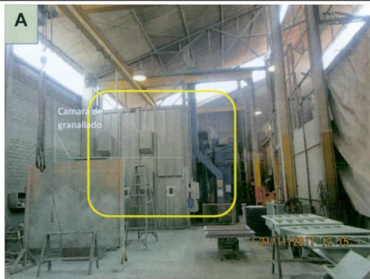
**Foto 19A:** Cámara de granallado, cuya área es de 5x4 mt, se emplea aproximadamente 25k de granalla por una caja de transformador tratada. La cámara de granallado es un espacio cerrado. La implementación no estuvo contemplada en el instrumento de gestión ambiental aprobada de la unidad fiscalizada.
