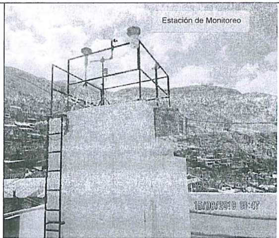
Fotografía N° 2: Vista de los equipos de medición por el método continuo de SO 2 del OEFA y equipo meteorológico.
