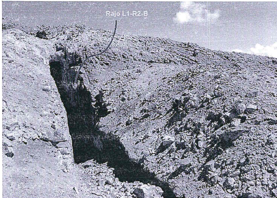
Fotografía N° 31: Vista cercana del rajo L1-R2-B, ubicada en coordenadas UTM (WGS 84), E: 222168 N: 8922939, se encuentra abierto, no se ha realizado el relleno de este componente. Se observa fragmentos de roca de tamaño pequeño a su alrededor.
