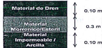
Figura N° 2.1-2 Cobertura Tipo 1 (Caso Generador)
