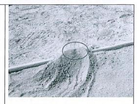
Foto N° 73. Coordenadas UTM Sistema WGS84 471863E 9526527N / Batería 2, se observó n la unión de dos (2) tuberías fuga de gas se emite al ambiente en forma constante.
