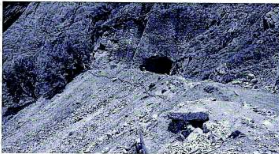
Foto 14: Depósito de desmonte adyacente a la bocamina "Ventana Berlin" en el nivel 4410.
