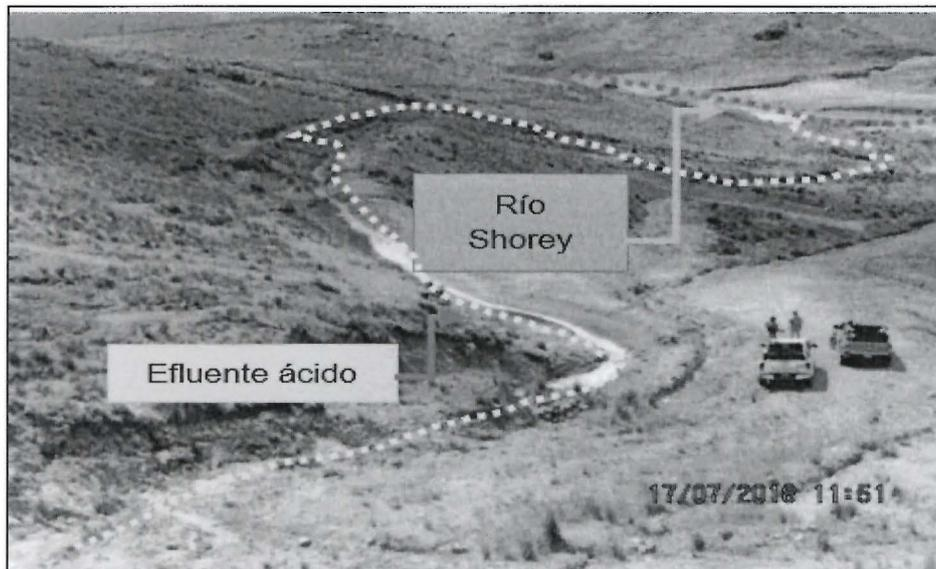
**Fotografía N° 16:** Vista del recorrido del efluente de la bocamina la paloma, la cual discurre por un canal de tierra de aproximadamente 300 m hasta su descarga al río Shorey, sin haber recibido de manera previa un tratamiento.
