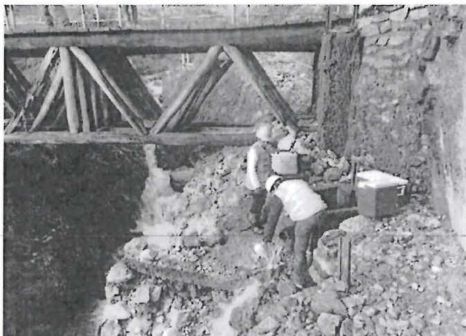
Fotografía N° 20.- Se aprecia al personal de laboratorio Envirotest, obteniendo una muestra en el punto de control PM-24 Efluente proveniente de la bocamina B-RE-1.
