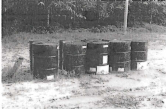
Foto N° 21. Pozo Tambo 01X, donde se observan nueve (09) cilindros de productos químicos vacíos sin sistema de contención de derrames. Coordenadas UTM - WGS84 350102E 9680210N.
