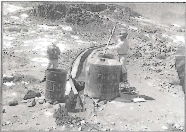
FOTOGRAFÍA N° 127.- Hallazgo N° 12: El agua de mina procedente de la bocamina Benevento es tratado con cal y floculante de forma manual.
