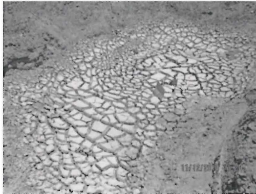
Fotografía N°117. Lodos de perforación diamantina sobre el suelo, cerca del depósito temporal de RRSS
