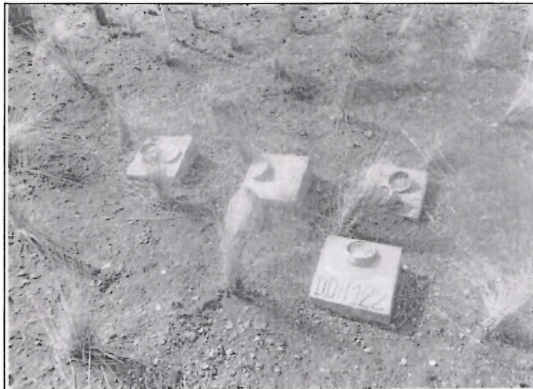
Fotografía N° 109: Dados de concreto de las sondajes u orificios DDH-100, DDH-103, DDH-108, DDH-112, DDH-119 y DDH-122 de perforaciones realizadas en la plataforma 58.
