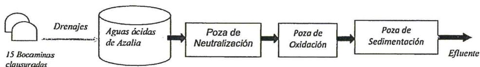
Esquema de Tratamiento de Aguas de Drenaje Bocaminas Azalia
