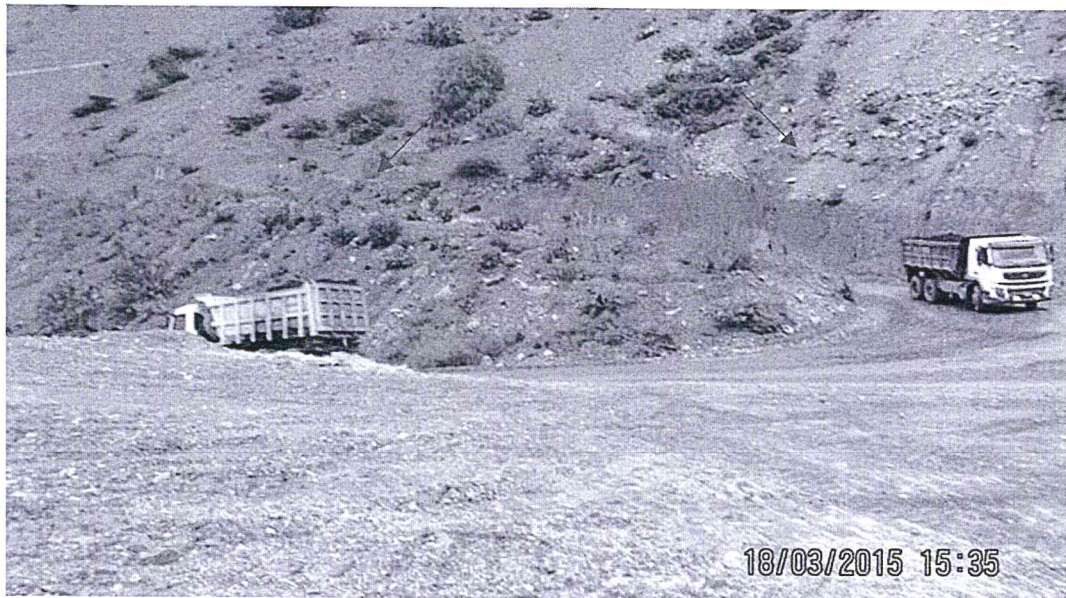
Fotografía N° 22. Se constató que el relave cargado en los vehículos que transportaban el relave hacia el depósito de relave Chacapampa supera el límite de la tolva del vehículo
