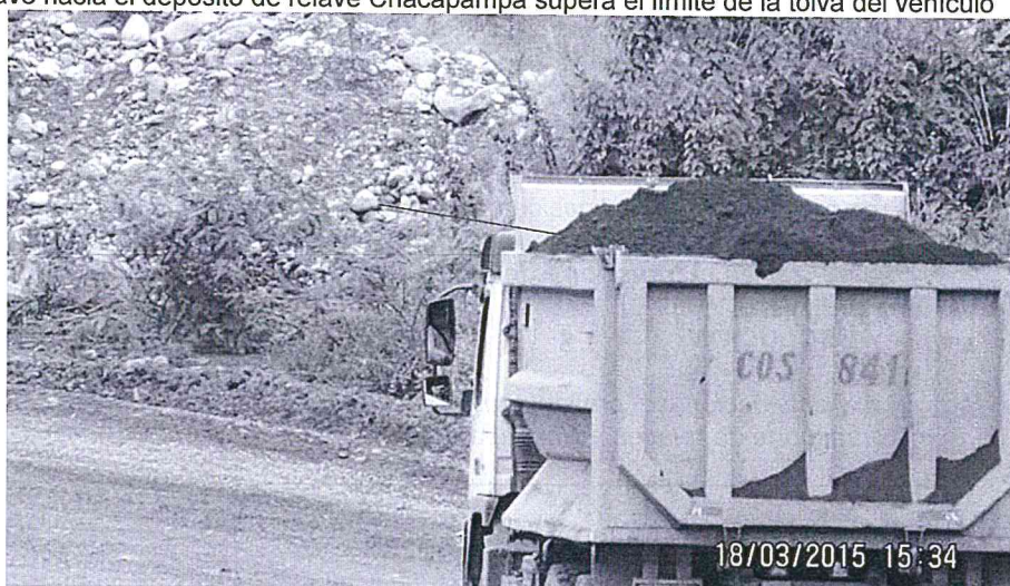
Fotografía N° 16. Se constató que el relave cargado en los vehículos que transportaban el relave hacia el depósito de relave Chacapampa supera el límite de la tolva del vehículo
