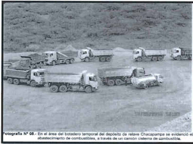
Fotografía N° 08.- En el área del botadero temporal del depósito de relave Chacapampa se evidenció el abastecimiento de combustibles, a través de un camión cisterna de combustible.
