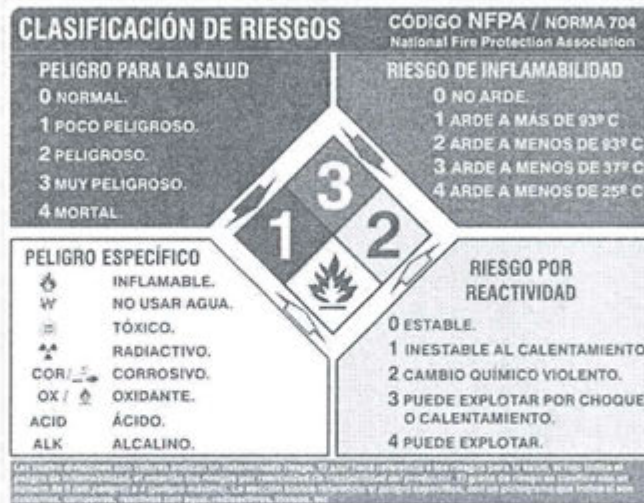
Figura N° 2: Vista de la codificación NFPA 704 11
