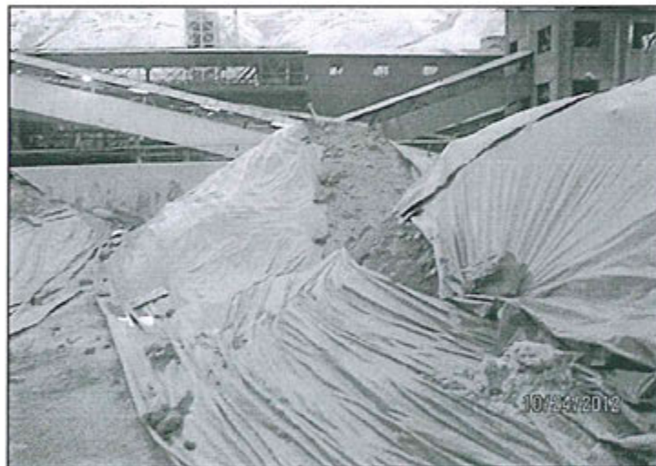
Hallazgo N° 43: Fotografía N° 101: Almacenamiento de materiales recirculantes en la zona de Ramada N° 1 de línea alta, los cuales no están cubiertos totalmente y no cuentan con estructuras hidráulicas.
