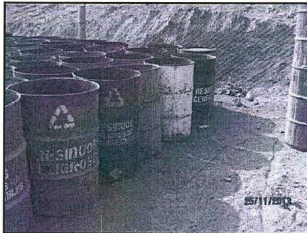
Fotografía N° 150 del Informe de Supervisión: Hallazgo N° 1-2013. En el almacén temporal de residuos sólidos industriales, otra vista de cilindros de color rojo sin tapa, mezclados con cilindros de diferentes colores, se evidencia una mala clasificación de residuos peligrosos y no peligrosos.
