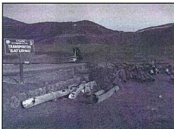
Fotografía N° 155 del Informe de Supervisión: Hallazgo N° 2-2013. En un área adyacente a las instalaciones de la contrata Saturno, en las coordenadas UTM (WGS84): Este 326423 y Norte 8596275, se encontró mala disposición de residuos industriales (tubería con yeso, chatarra, tuberías en desuso).
