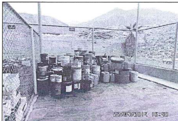
Fotografía N° 14. Vista de un ambiente dentro del almacén temporal de residuos peligrosos, se aprecia que los envases de aceites se encuentran posicionados sobre una geomembrana.
