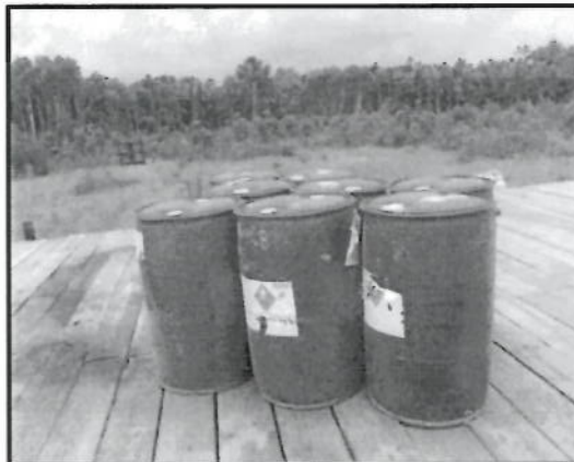
Fotografía N° 45: Vista de almacenamiento de productos químicos en un área sin impermeabilizar y sin sistema de contención de derrame.
