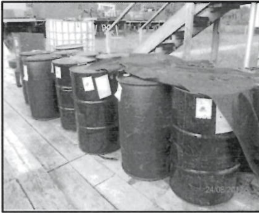
Fotografía N° 28: Plataforma 32X del Yacimiento de Yanayacu, vista de almacenamiento de productos químicos en áreas inadecuadas que no cuentan con sistema de contención de derrame y tampoco se encuentra impermeabilizada.
