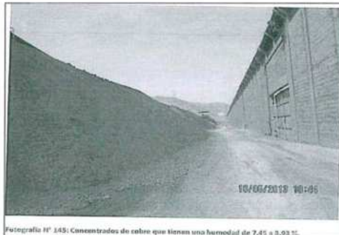
Fotografía N° 145: Concentrados de cobre que tienen una humedad de 7,45 a 9,93 %.
