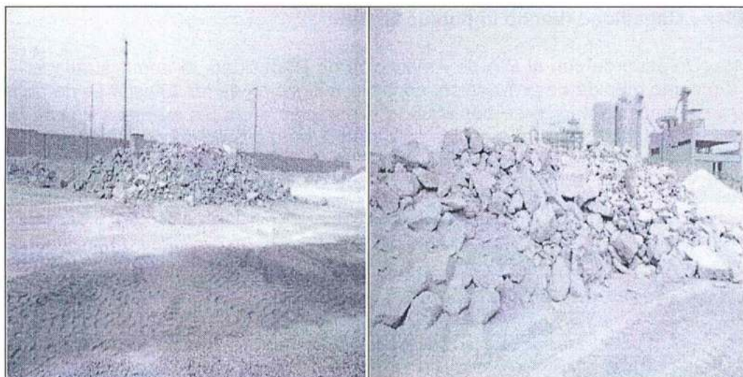
Foto 12.-Cancha de almacenamiento de caliza, sin barrera de separación, accesos sin afirmar y lógicamente expuestos a la acción del viento.
