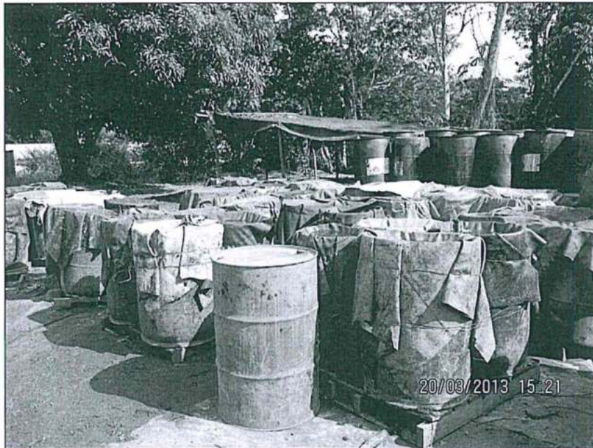
FOTOGRAFÍA N° 3: En el patio de borras ubicado en un ambiente abierto, se observó cilindros encapuchados con geomembranas, que contienen material impregnado de hidrocarburos.
