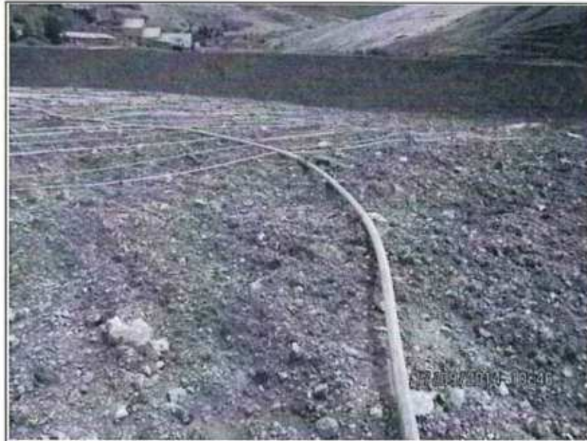
Fotografía N° 189: Vista de las cintas de riego en el pad de lixiviación. Hallazgo N° 16 (de gabinete)
