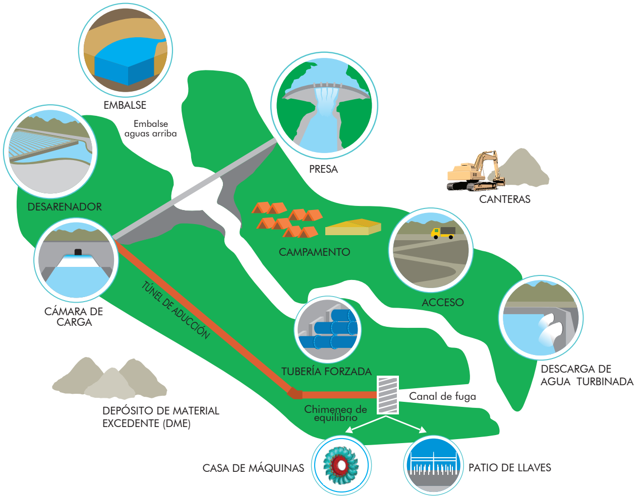
ESQUEMA DE UNA CENTRAL HIDROELÉCTRICA EN CONSTRUCCIÓN
