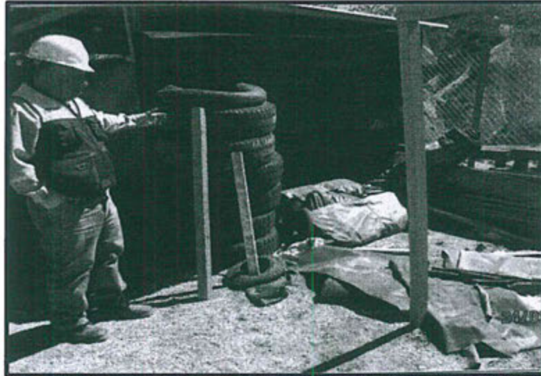
Fotografía N° 4: Centro de acopio de residuos temporales donde se muestra que los residuos sólidos industriales (llantas, mangueras, jebes y tuberías) está expuesto al ambiente. Hallazgo N° 2 – Supervisión Ambiental 2013
