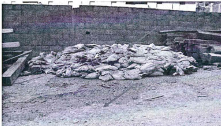
Fotografía 18: Bolsas que almacenan el material derramado a través del punto E-09 (residuos peligrosos), que se encuentran ubicados dentro del área donde se encuentra el sistema de sedimentación, no cuenta con un adecuado manejo y disposición de los residuos sólidos peligrosos.
