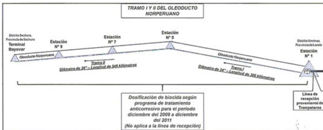
Gráfico N° 2 Aplicación de biocida en los Tramos I y II del Oleoducto Norperuano
